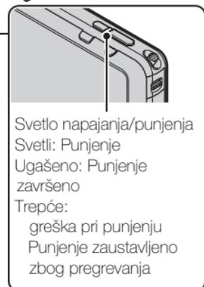
**1** Otvorite poklopac priključka i pomoću USB kabla sa višenamenskom priključnicom (isporučeno) spojite fotoaparat i AC ispravljač (isporučeno).
